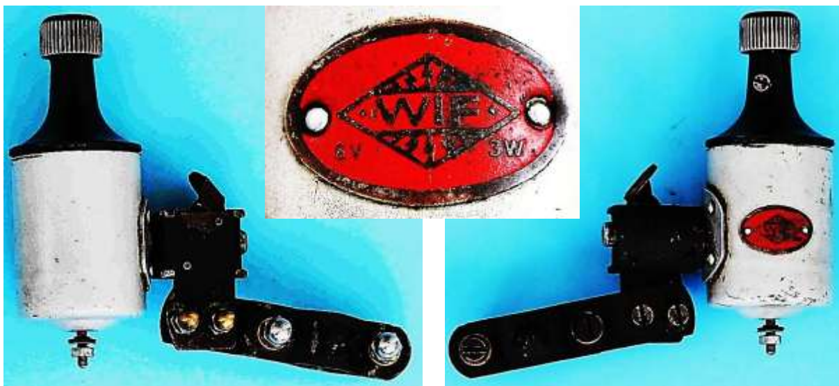
Bild 3.15: WIF 3 W mit Ölbohrung
