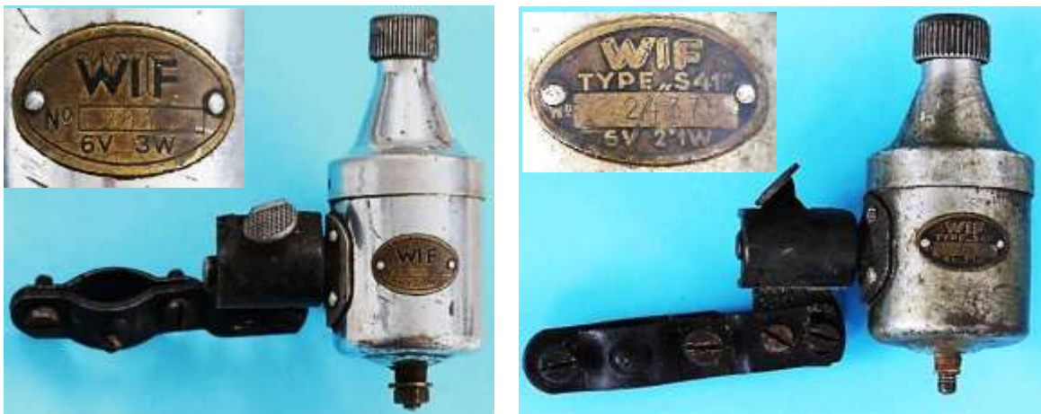
Bild 2.1: Zwei gleiche Konstruktionen für unterschiedliche Leistungen: a) Ohne Typenbezeichnung. Leistung 3 W, Fertigungsnummer 251, b) Typ S 41, Leistung 2,1 W, Fertigungsnummer 24378
