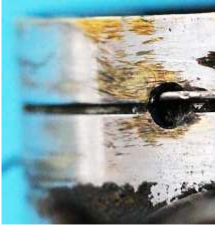
Bild 2.5: Einlegen des Federdrahtes: a) Haken in der Bohrung des Gehäusetopfes, b) Einziehen des Drahtes durch entgegengesetzte Verdrehungen der Gehäuseteile
