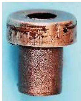
Bild 3.22: Oberes Gleitlager mit Blechkappe: a) Eingesetztes Gleitlager, b) Gleitla- gersitz, c) Blechkappe auf dem Bund des Lagers, d) Trennlinie zwischen der Blech- kappe und Lagerbund
