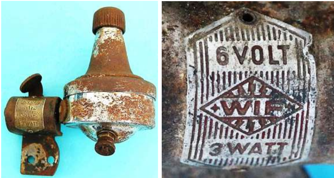
Bild 5.7: Verrostete Oberfläche des 10-poligen Dynamos
