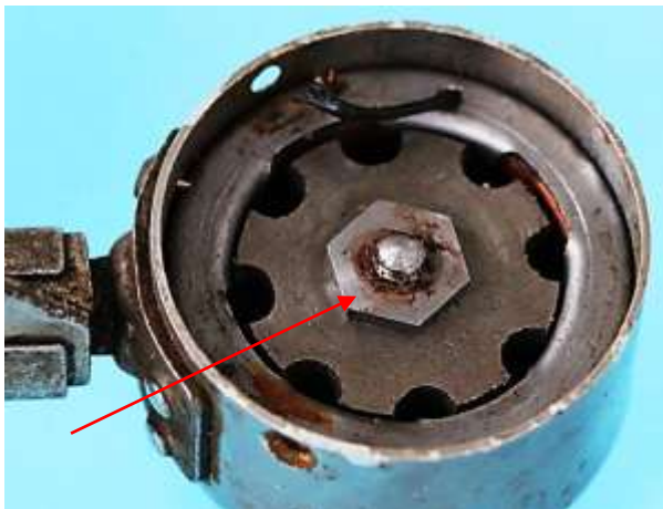
Bild 5.24: Polrad und Welle: a) Polrad auf der Welle verschraubt, b) Wellenende bei abgenommenem Polrad
