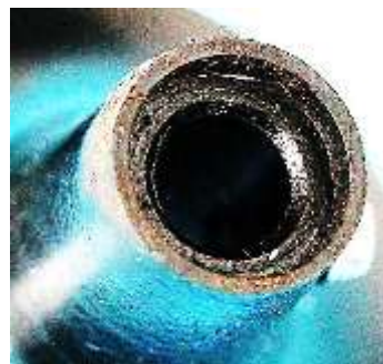
Bild 3.22: Oberes Gleitlager mit Blechkappe: a) Eingesetztes Gleitlager, b) Gleitla- gersitz, c) Blechkappe auf dem Bund des Lagers, d) Trennlinie zwischen der Blech- kappe und Lagerbund
