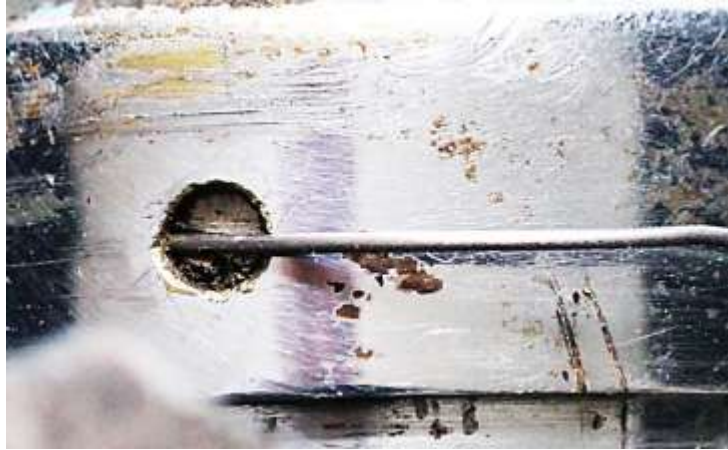
Bild 2.5: Einlegen des Federdrahtes: a) Haken in der Bohrung des Gehäusetopfes, b) Einziehen des Drahtes durch entgegengesetzte Verdrehungen der Gehäuseteile
