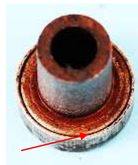
Bild 3.22: Oberes Gleitlager mit Blechkappe: a) Eingesetztes Gleitlager, b) Gleitla- gersitz, c) Blechkappe auf dem Bund des Lagers, d) Trennlinie zwischen der Blech- kappe und Lagerbund
