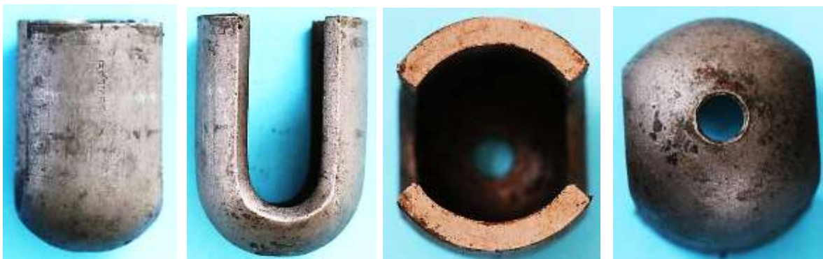
Bild 2.7: Zweipoliger Tulpenmagnet: Innendurchmesser 32,5 mm, Magnetdicke 5,5 mm, Magnethöhe 60 mm, Magnetgewicht 207 g.
