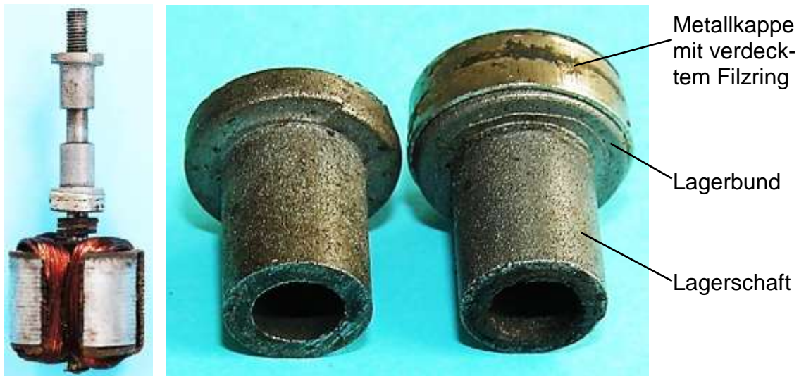
Bild 3.4: Lagerung mit zwei Kunststoffgleitlagern gleicher Abmessungen
