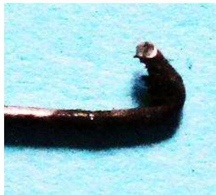
Bild 2.4: Federdraht mit Haken zur Verbindung von Lagerhals und Gehäusetopf
