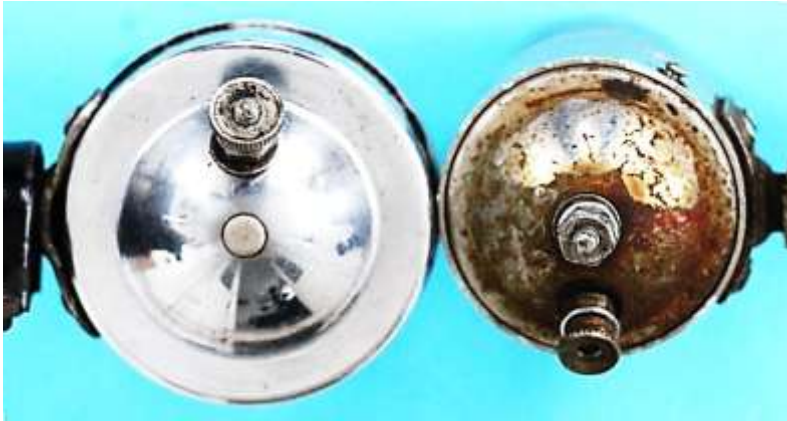
Bild 5.22: Gegenüberstellung der Böden von zwei Dynamogenerationen mit rotierendem Polrad und einem Klauenpolanker in radialer Bauweise
