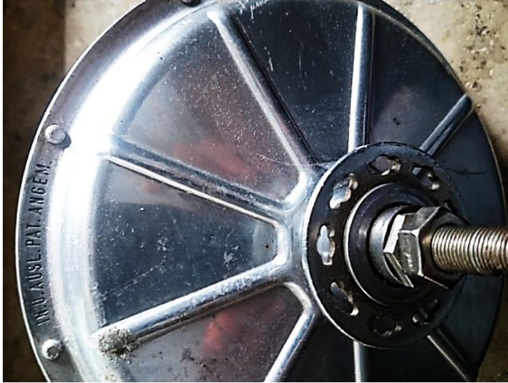
Bild 4.7: Knopfloch-Speichen-löcher des Nadyo-Dynamos
