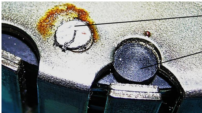
Bild 4.15: Spulenanschlüsse: a) Massekontakt, b) Einführung des Spannung führenden Drahtes in die Achsenbohrung, c) Herausführung des Spulenendes
