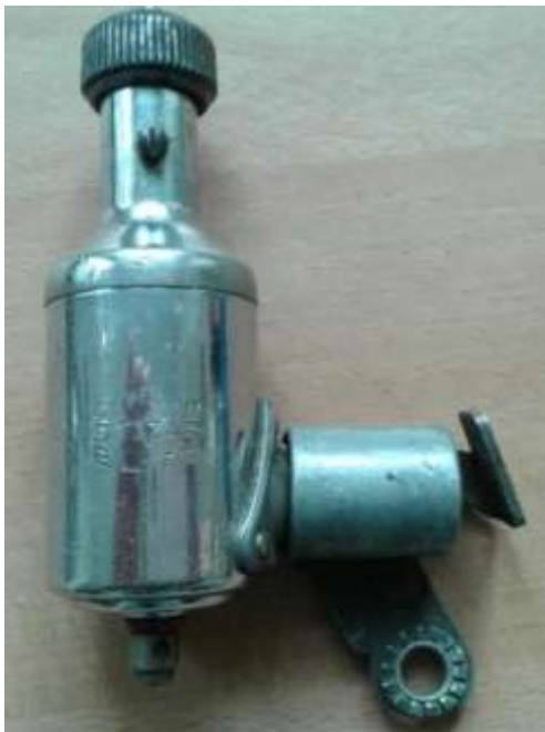
Bild 2.4: TMI-Star-Elite 6 V; 4W
