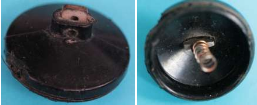
Bild 3.3: Bodenteller: a) Kabelanschluss b) Metallstück mit Feder
