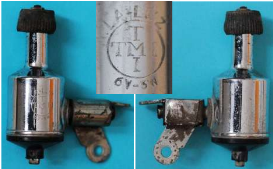
Bild 3.1: LA-LUZ mit Klauenpolanker
