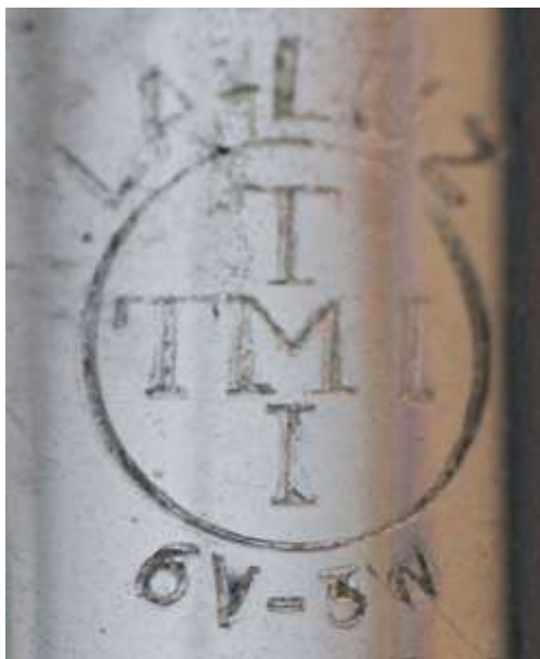
Bild 3.2: Beschriftung des Gehäusemantels mit den eingekreisten Buchstaben TMI, dem Markennamen LA-LUZ und den Nenndaten
