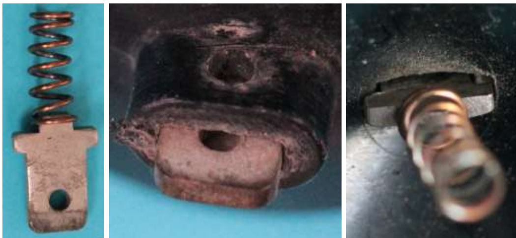
Bild 3.4: Kabelanschluss: a) Durchbohrtes Metallstück mit Schraubenfeder, b) Führung des Metallstücks im Gehäuseboden, c) Innere Ansicht des Spannung führenden Kontakts
