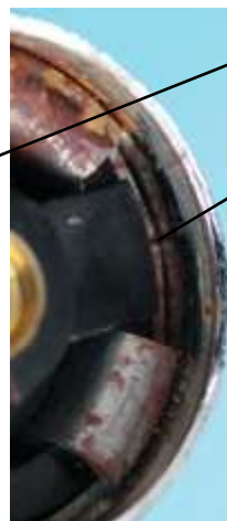
Bild 3.5: Generatorbauteile: a) Zentrische Anordnung von Polrad und Anker, b) Fügeschlitz im Ankerrücken
